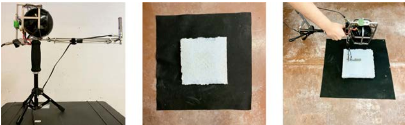
Figura 10.7. De izquierda a derecha: probeta lista para ensayo, sistema micro-flow in-situ absorption set , ensayo con pistola de impedancia (Serrano Gámir, 2022).
