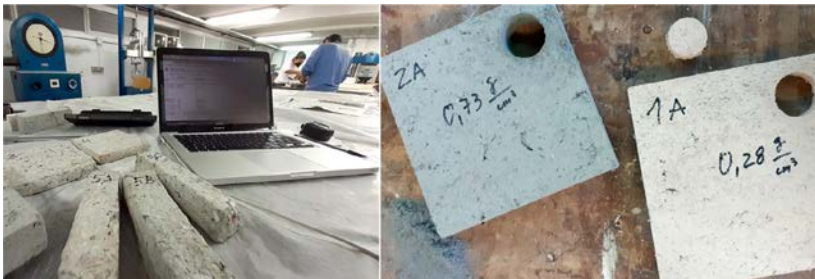
Figura 10.1. Caracterización de muestras en base a celulosa. Laboratorio de materiales, ETSAM/UPM.
