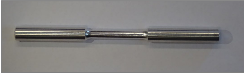
Ilustración 2.- Probeta de tracción según norma ISO 6892-1:2016.
