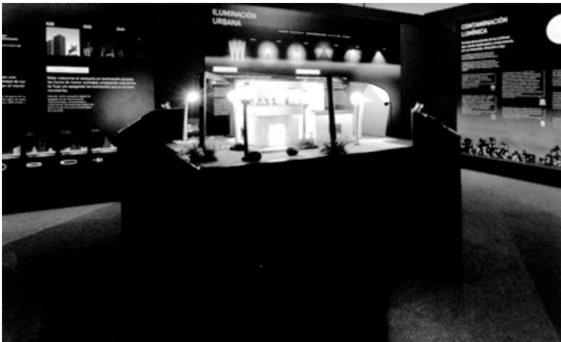
Figura 2. Módulo didáctico: maqueta interactiva que permite medir la luz proyectada por diferentes luminarias y su nivel de contaminación.
