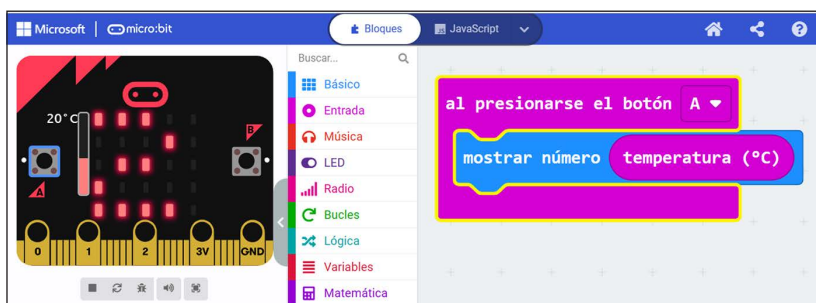
Figura 1. Programación por bloques. Sensor de temperatura
