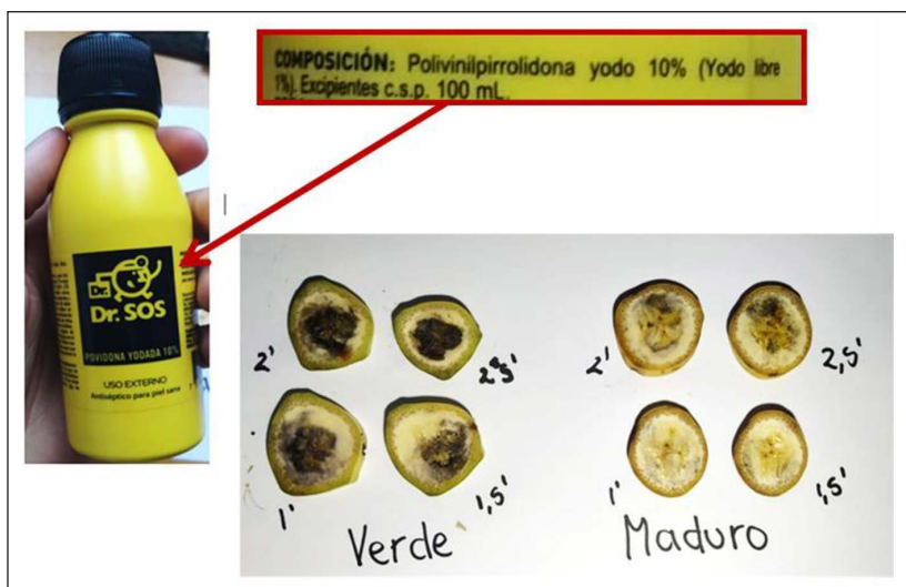
Figura 2. Ejemplo de respuesta a desafío consistente en la realización de un experimento casero. En este caso, se aprecia el mayor contenido en almidón del plátano verde (izquierda) frente al maduro (derecha), mediante la tinción con yodo de un producto antiséptico comercial.
