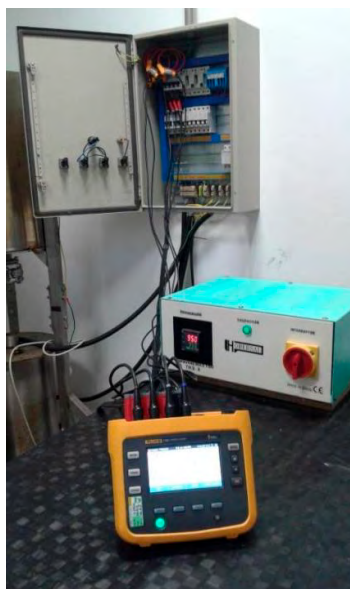
Figura 3.2. Analizador Fluke 1736 en el momento de la recopilación de datos
