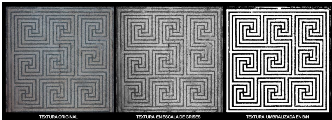
Figura 2. Transformación de una imagen original (izquierda) en una imagen en escala de grises (centro) y otra en umbral de blancos y negros (derecha)
