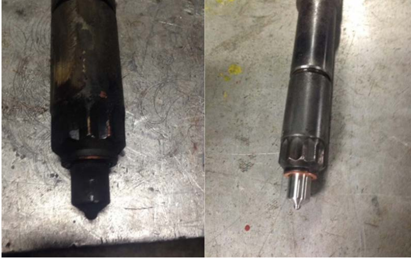
Figura 2.2. Inyector usado durante 5000 h e inyector nuevo para reemplazo. Fuente: elaboración propia.
