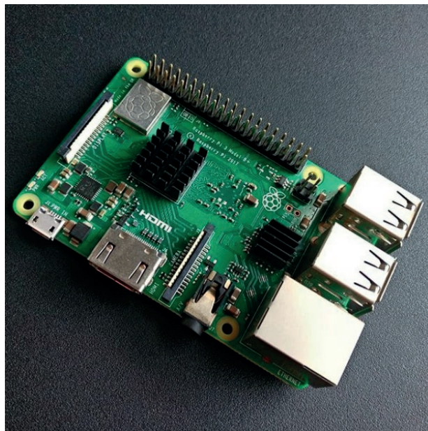
Imagen 1. Dispositivo IoT1: Raspberri Pi como las que han usado los alumnos.
