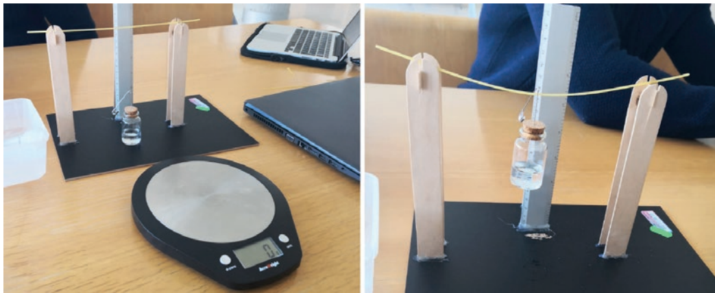
Figura 4. Ensayo de flexión de tres puntos utilizado para la caracterización de los espaguetis por uno de los equipos participantes en el proyecto.
