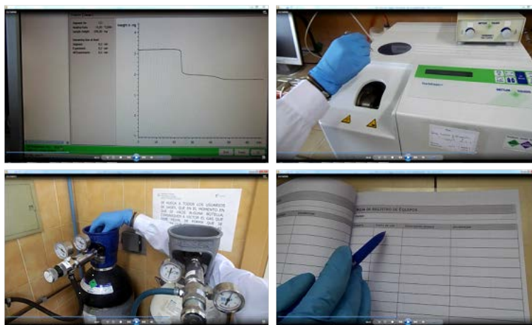
Figura 3. Secuencia de imágenes donde se detalla el procedimiento de apagado del equipo.
